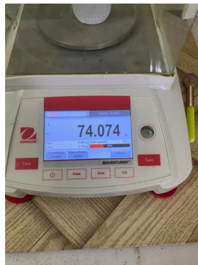
Figure III.8 : Pesée du résidu après calcination ( P_2 = 74,074 g).
