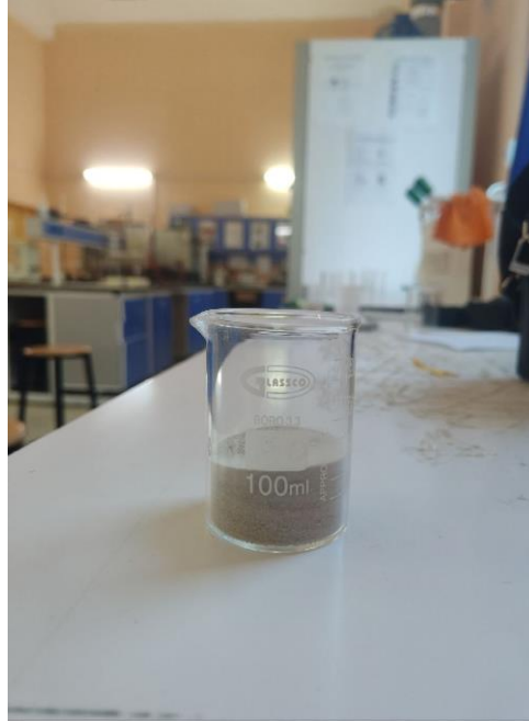
Figure III.4 : Mise en suspension de 1 g de support phosphaté dans 100 mL d'eau distillée pour la détermination du pH de surface.
