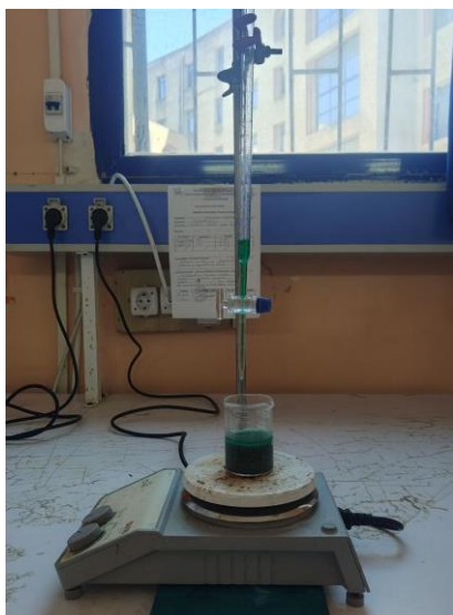
Figure III.11 : Imprégnation du support phosphaté P/SiO_2 par la solution de nickel, sous agitation magnétique pendant 30 minutes.
