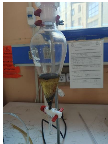
Figure III.14 : Détail de la séparation des deux phases dans l'ampoule à décanter : phase supérieure jaune dorée (huile estérifiée) et phase inférieure sombre (glycérol, méthanol et résidu de catalyseur).
