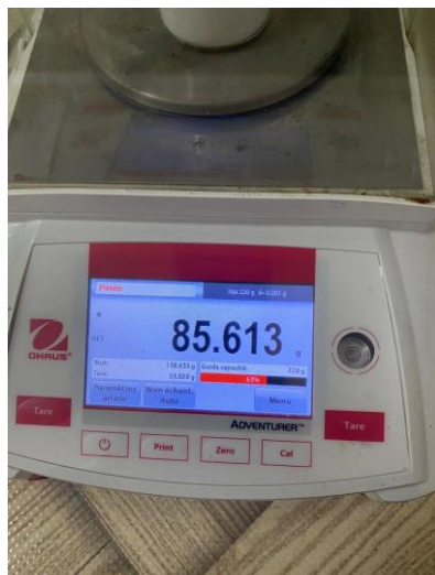
Figure III.7 : Pesée de l'échantillon avant calcination ( P_3 = 85,613 g).
