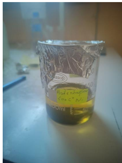
Figure III.16 : Huile estérifiée récupérée après réaction avec le catalyseur Ni/P-SiO 2 .calciné à 500 °C, conservée sous papier d'aluminium en attendant les analyses ultérieures.
