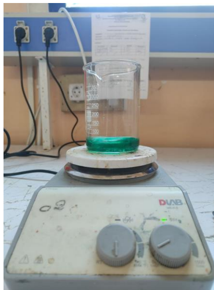
Figure III.10 : Solution verte homogène obtenue après dissolution complète de nickel dans l'eau distillée, sous agitation magnétique pendant 10 minutes.
