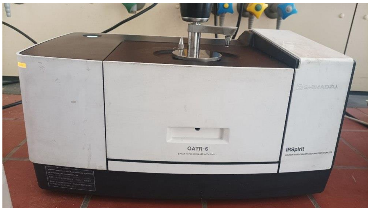
Figure III.3 : Spectromètre infrarouge à transformée de Fourier (FTIR) Shimadzu IR Spirit équipé de l'accessoire ATR, utilisé pour la caractérisation infrarouge des échantillons.
