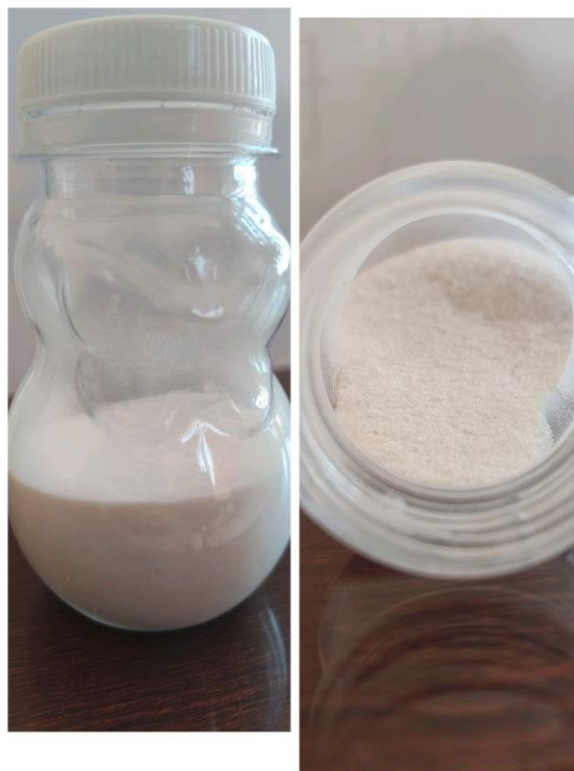
Figure III.2 : Aspect visuel de la poudre fine et homogène de gel de silice activé obtenue après séchage et broyage.
