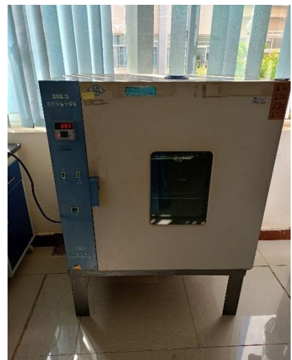
Figure 6 : Etape 2. Figure 7 : Séchage dans une étuve. Figure 8 : Etuve model 202.
