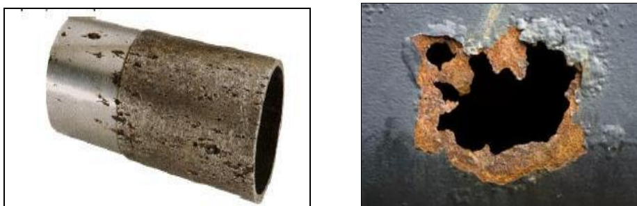
Figure I. 5 : Corrosion par piqûre d'un acier.
