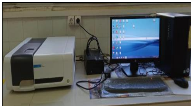
Figure III.10: Appareil d'un Spectroscopie ultraviolet-visible
