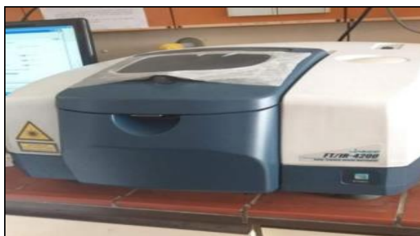
FigureIII.9: Appareil d'un Spectroscopie infrarouge
