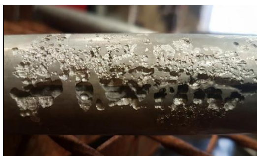
Figure I.9 : la corrosion caverneuse des aciers inoxydables.
