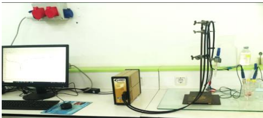
Fig.IV.7. Potentiostat/Galvanostat GAMRY Référence 6
