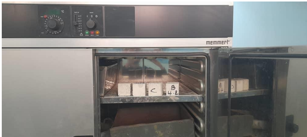
Figure III-18: Eprouvettes prismatiques 4x4x16 cm pour l'essai d'absorption par immersion
