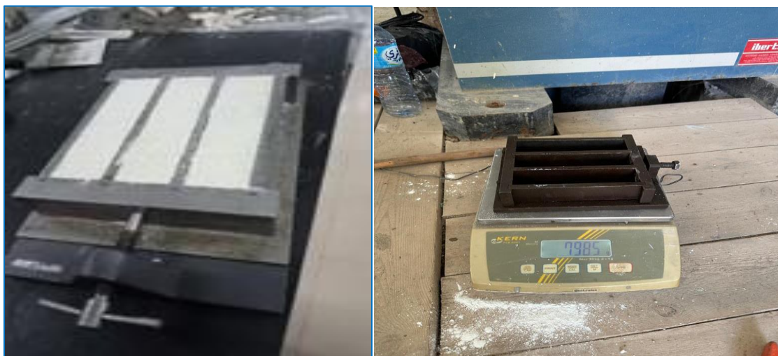
Figure III-2: Moule triple pour prismes 4x4x16 cm 3
