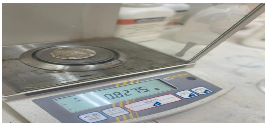
Figure22 : poids du papier filtre après filtration et séchages du site 2. Photo personnelle.
