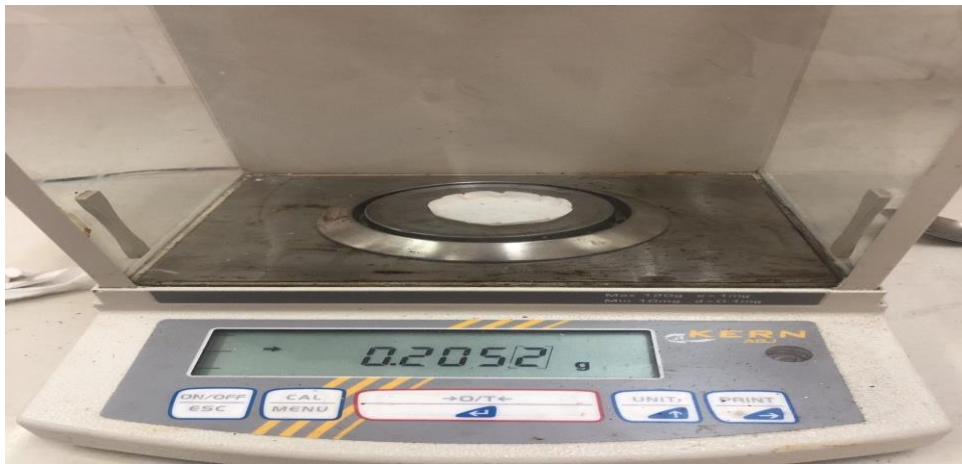
Figure 24 : poids du papier filtre après filtration et séchages du site 3. Photo personnelle.
