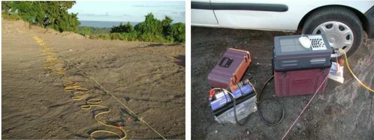
Figure 2.4- Dispositif MASW (à gauche : «flûte» de géophones, à droite: station d'acquisition).
