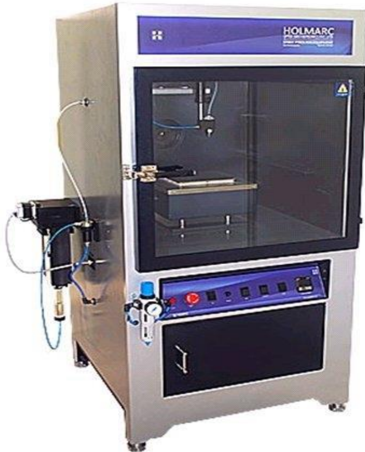
Figure III.1 : Dispositif de dépôt par spray ultrasonique utilisé (Université Mentouri-Constantine).
