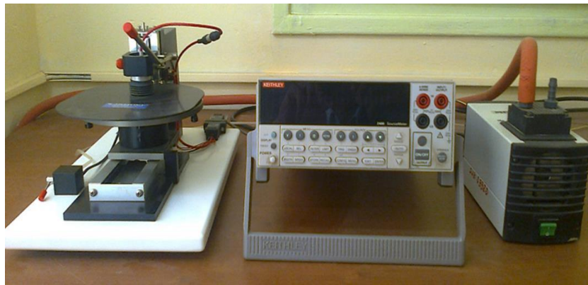
Figure III.11 : L'appareillage de mesure électrique (Jandel 8 ème model) utilisé (LRPCSI- université de Skikda).
