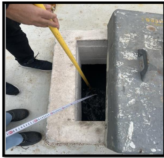
Figure II 11 : Mesure de la hauteur de la calcite
