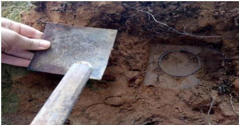
Figure16: Prélèvement de l'échantillon sur terrain pour mesure de la densité apparente Matière organique (Méthode de calcination)
