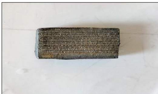
Figure III.7: Revêtement à base de Nickel.
