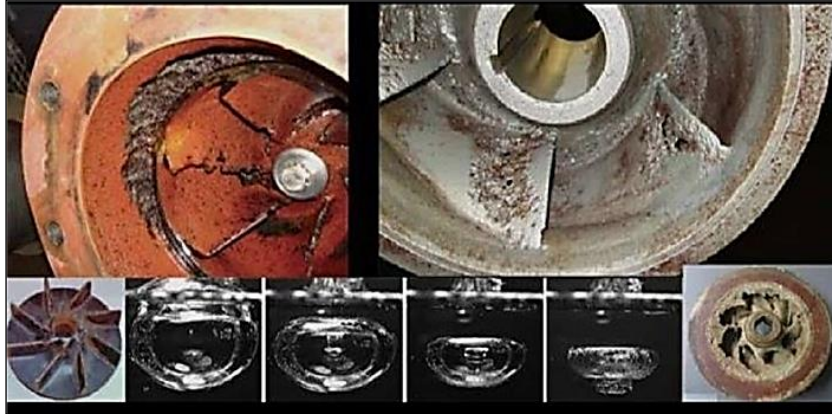
Figure I.10: Corrosion par cavitation [17]
