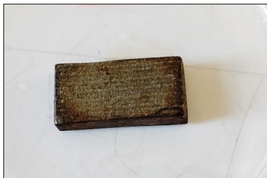
Figure III.6: Revêtement à base de Cobalt
