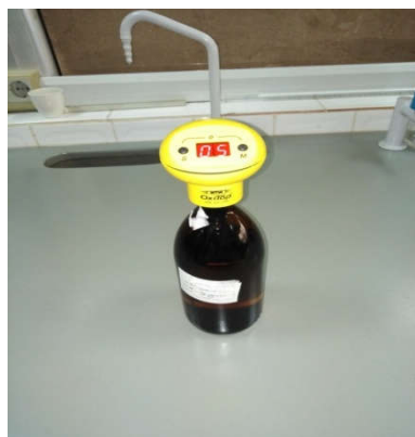
Figure IV.9 : bouteille d'incubation pour l'analyse de la DBO_5
