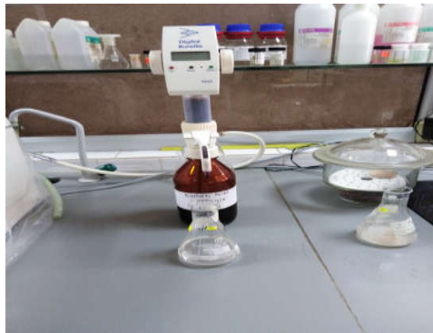
Figure IV.7 : montage de titrage pour l'analyse de la DCO
