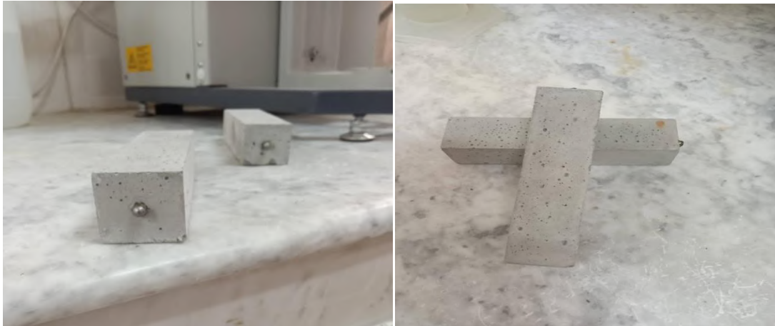
Figure III-21: Epreuves prismatiques équipées de plots.
