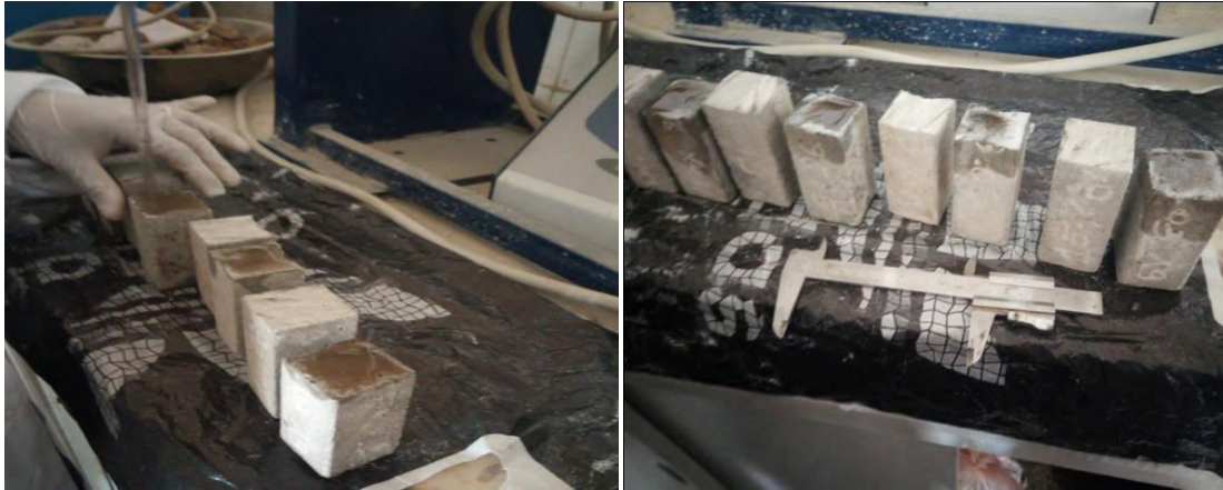
Figure III-20 : Versement des nitrates d'argent \text{AgNO}_3 et mesure de la profondeur de pénétration des chlorures.
