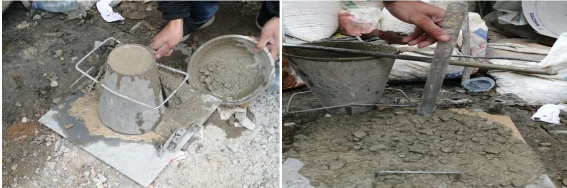
Figure III-28 : Essai d'affaissement au cône d'Abrams.
