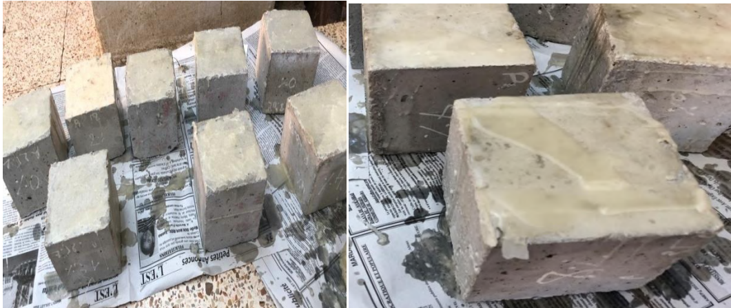
Figure III-40: Essai pénétration des ions chlorures.
