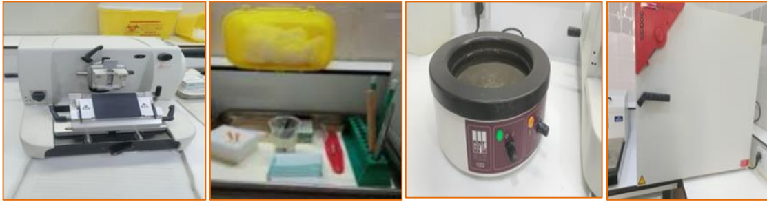
Figure 8 :matériels de la coupe A-microtome, B- lames, C- bain marie, D- l'étuve 140°C. (Photos originale, 2025).
