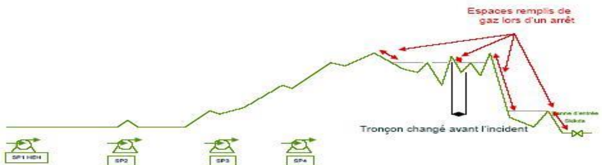
Figure III.12. Poches de gaz dans l'oléoduc OK1 [14].
