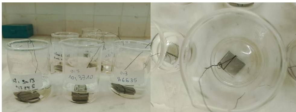
Fig.IV.23 : Immersion des échantillons dans les solutions préparées.
