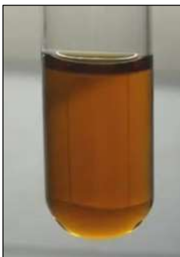
Fig.V.1 : Mise en évidence des flavonoïdes.
