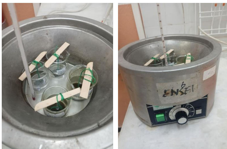
Fig.IV.17 : Effet de la température sur la corrosion.
