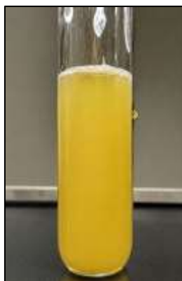
Fig.V.2 : Mise en évidence des alcaloïdes par le test de Mayer.
