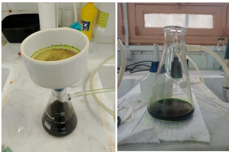
Fig.IV.10 : Montage de filtration Buchner (sous vide).
