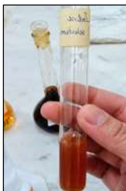
Fig.V.3 : Mise en évidence des alcaloïdes par le test de wagner.
