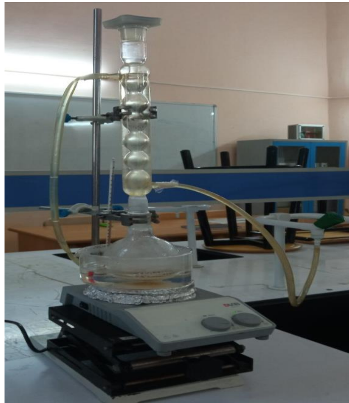
Figure IV - 18: Dispositif de la synthèse de l'obtention du PS
