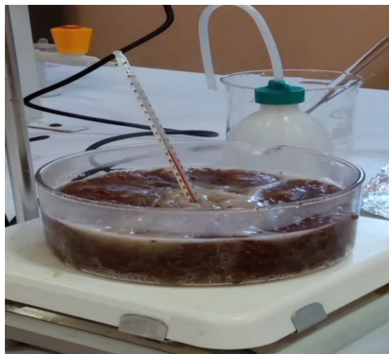
Figure IV - 15: Extraction du gel par ébullition des grains de lin
