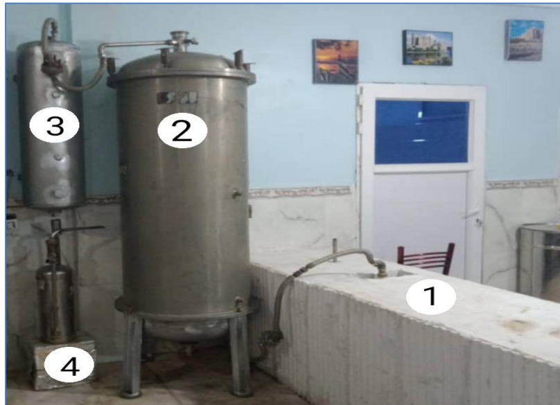
Figure 15 : Montage de l'entraînement à la vapeur d'eau.
