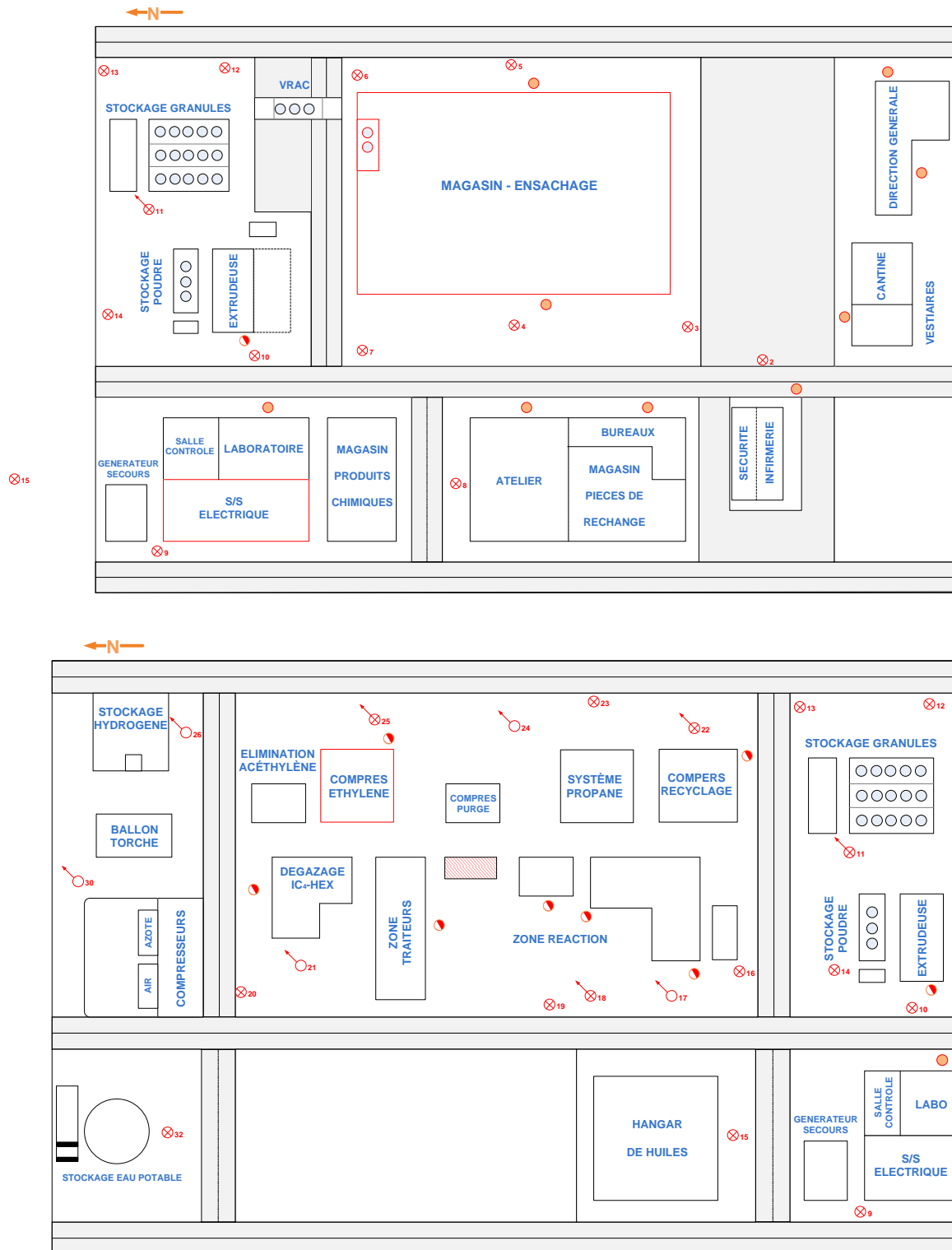
Fig.3.18. Réseau anti incendie installé dans l'unité CP2K
