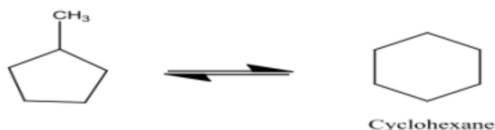
Fig. I.18: la réaction de l'isomérisation de l'alkylopentane en alkylohexane [31].
