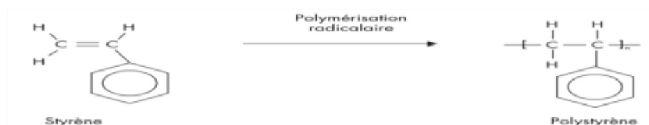
Fig. I.8: La polymérisation de styrène en polystyrène [28].
