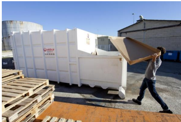
Figure 9 : Benne-compacteur pour la collecte des cartons (d'emballages ou non) et des papiers rachetés par Veolia
