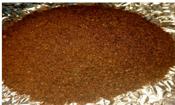
Figure III.4 : Les coquilles de châtaigne activées après broyage et tamisage.
