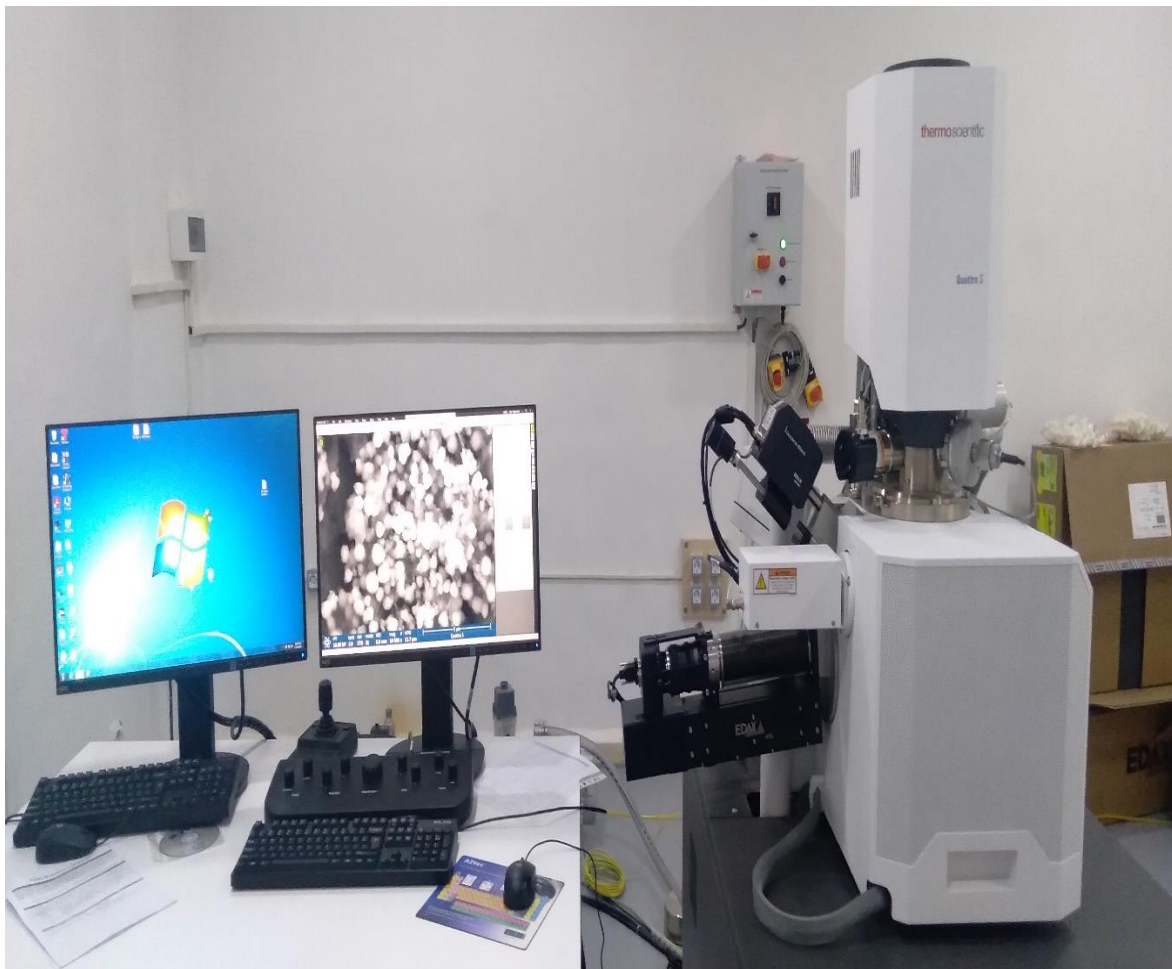
Figure II.3 : Appareil de MEB couplé à l'EDX.
