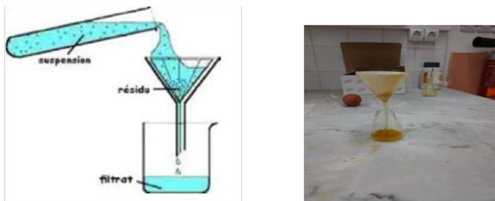
Figure IV. 3 : Montage pour filtration simple
