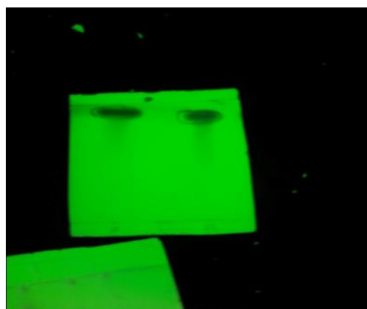
Figure IV. 6 : Utilisation plaque CCM du produit 3b
