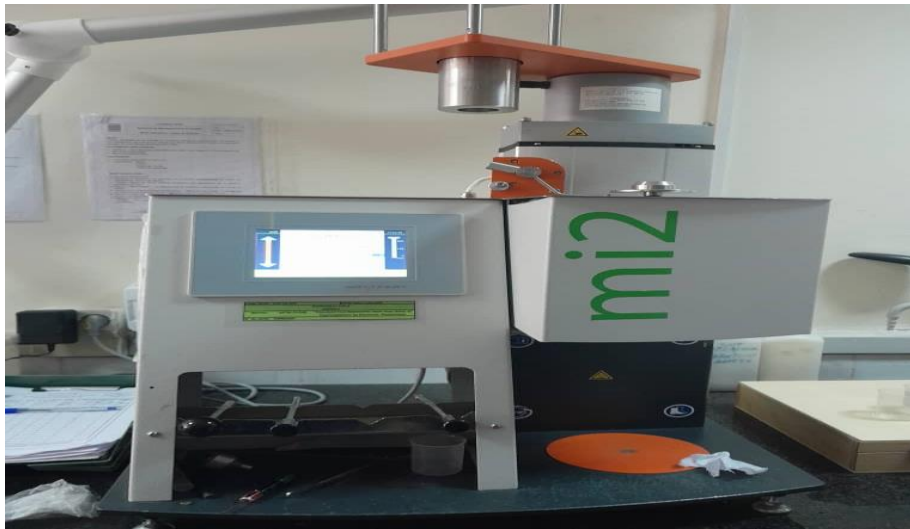
Figure III.13: Appareillage de mesure du Melt Flow Index.
