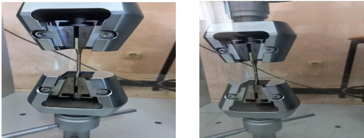
Figure III.16 : Machine de traction type Test Kallibrierlabor modèle 918239.
