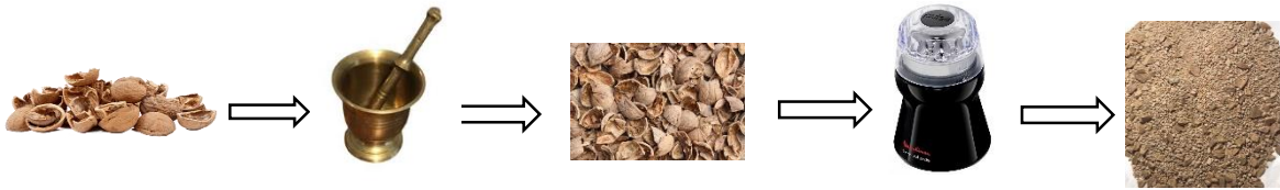
Figure III.2: Les étapes de la préparation de poudre de coquille de noix.
