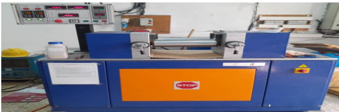
Figure III.6 : Malaxeur de type (ROULEAUX DE LABORATOIRE BIQAP LAP.
