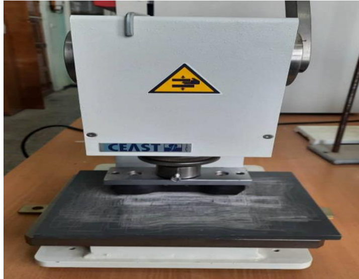
Figure III.10 : Appareillage d'une poinçonneuse « Presse pneumatique à découper ».
