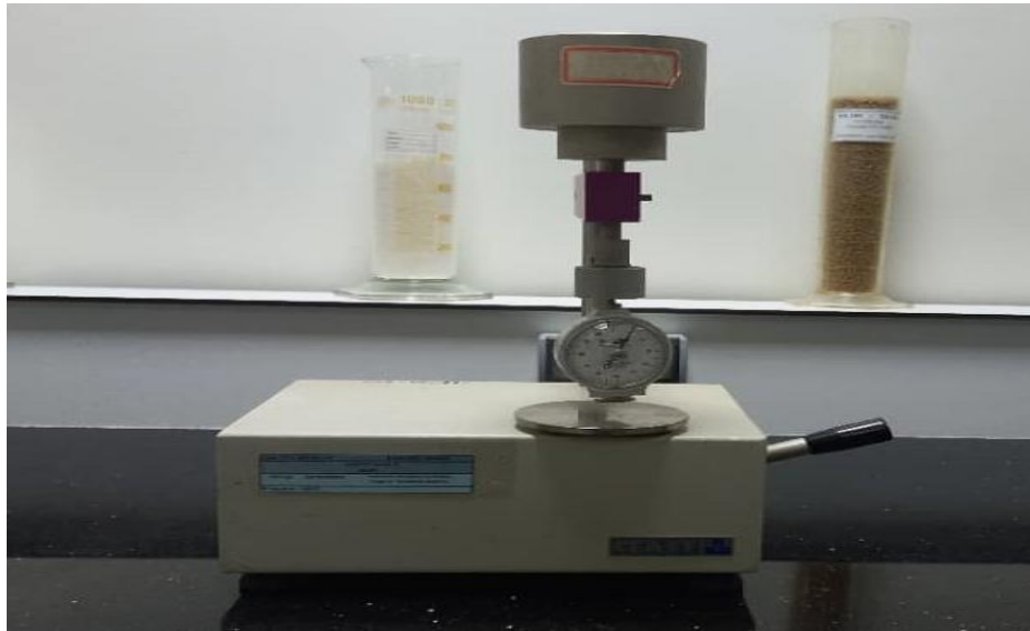
Figure III.15 : Appareillage de mesure de la dureté Shore D.
