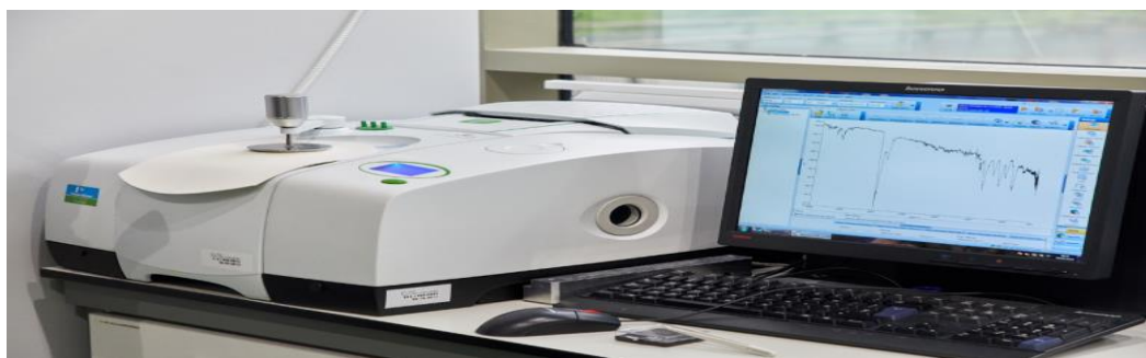
Figure III.12. Spectrophotomètre Perkin-Elmer (FTIR-ATR)
