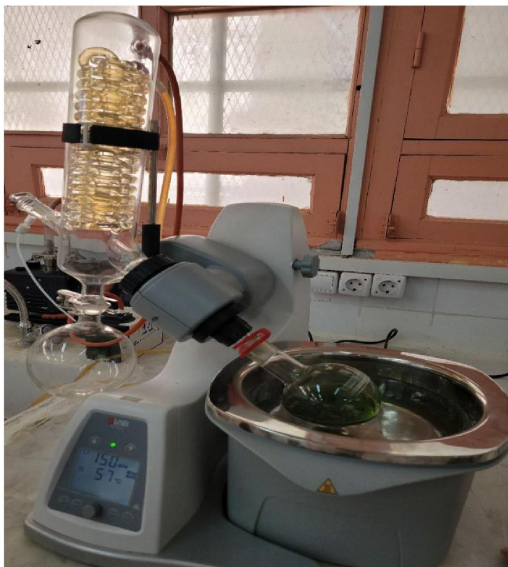
Figure 08 : Dispositif de l'évaporateur rotatif
