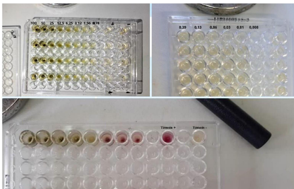
Figure 39 : Photographie de la microplaque pour les CMI de l'extrait de Jania rubens
