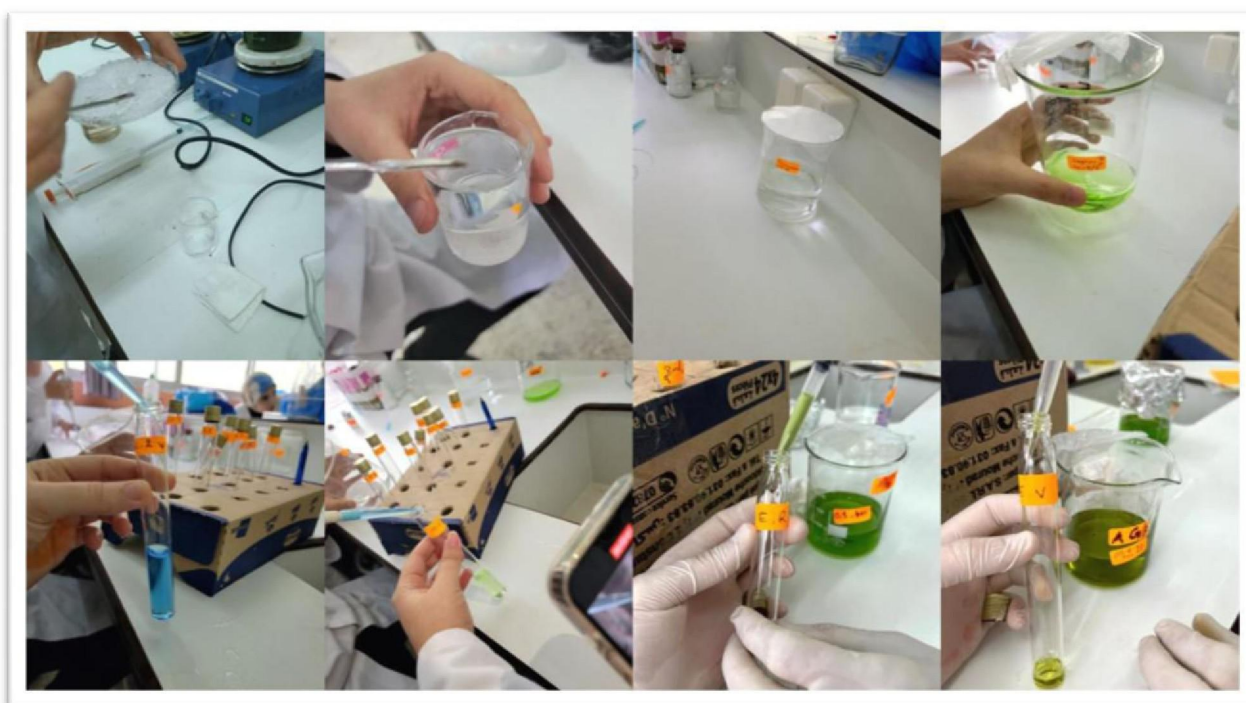
Figure 17: Test de l'activité antioxydante par réduction cuprique
