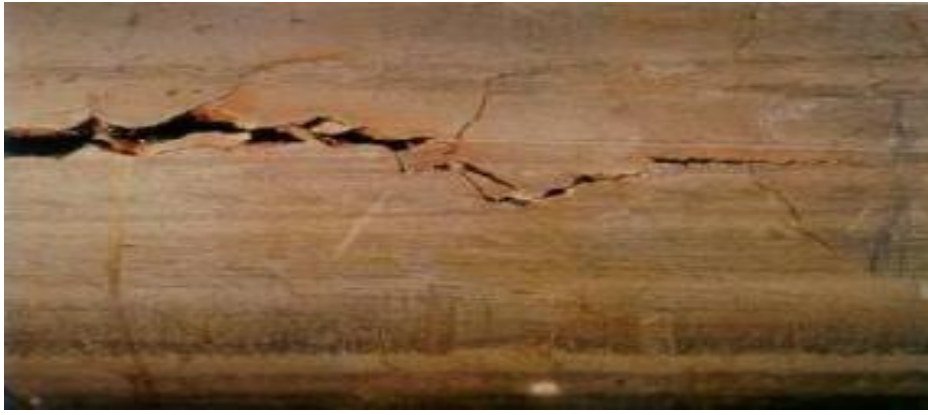
Figure.I.4 : Corrosion sous contrainte d'un tube en acier inoxydable en présence de quelques ppm de chlorures. [5]
