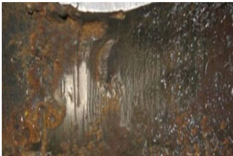
Figure .I.5 : Corrosion sous contrainte en présence d'une pression partielle de sulfure d'hydrogène (H 2 S) élevée. [5]
