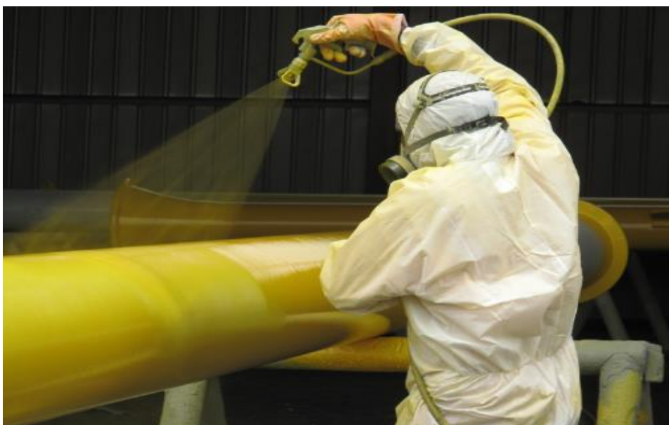
Figure.I.21. protection du payp par revetements [37]
