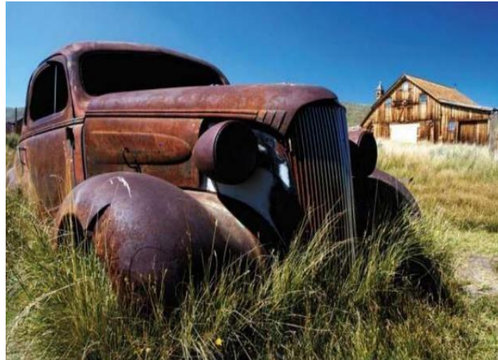
Figure.I.1 : Corrosion généralisée d'une surface métallique [5]
