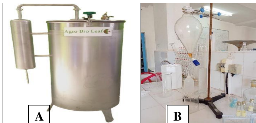
Figure 5. A : Appareil d'hydrodistillation à la vapeur, B : Entonnoir séparateur (Tradi, 2024).
