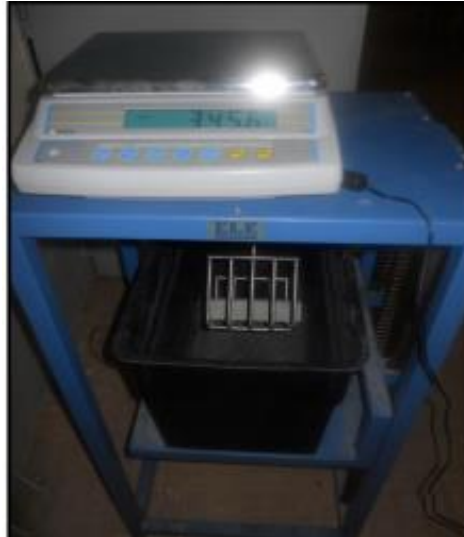
Figure 3.27. Mesure du poids hydrostatique.
