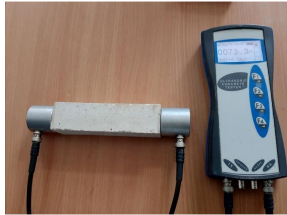
Figure 3.25. Mesure de la vitesse ultrasonique d'une éprouvette.
