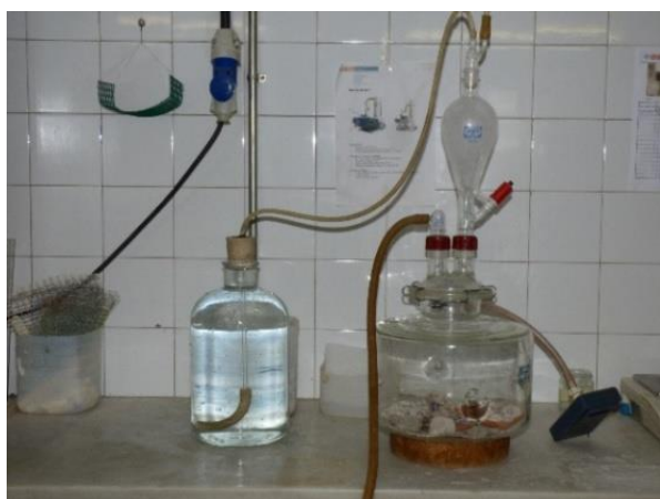
Figure 2.10. Dispositif de l'essai de la porosité accessible à l'eau
