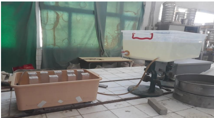
Figure 3.26. Essai d'absorption d'eau par capillarité.
