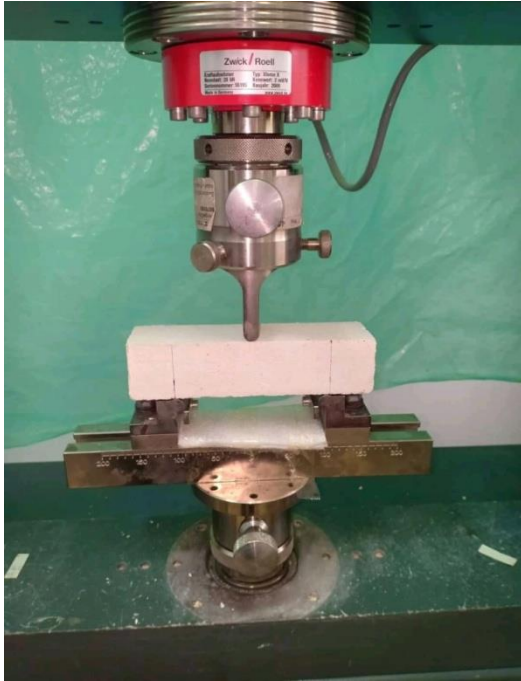
Figure 3.22. Essai de traction par flexion 3 points.
