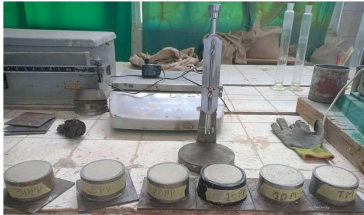
Figure 3.21. Détermination des délais de prise avec l'Appareil de Vicat.
