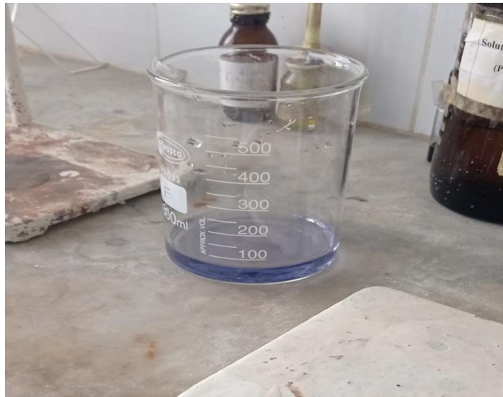
Figure 13 : Titration du THT par l'EDTA.
