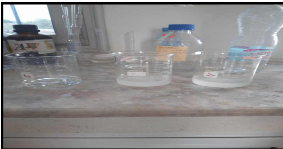
Figure 18 : Dosage du Sulfate par Chlorures de baryum.
