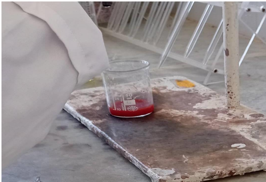
Figure 12 : Titrage des chlorures avec nitrate d'argent \text{AgNO}_3
