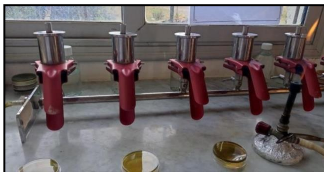
Figure 16 : Rampe de filtration
