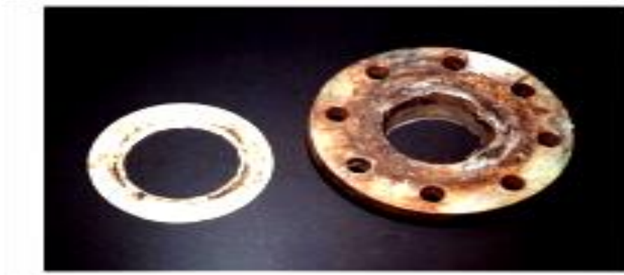
Figure I.4 : Aspect et mécanisme d'attaque de la corrosion caverneuse.
