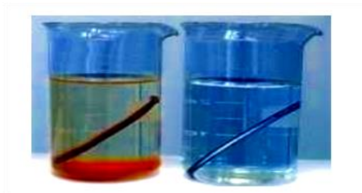
(a) sans inhibiteur de corrosion (b) avec inhibiteur de corrosion
