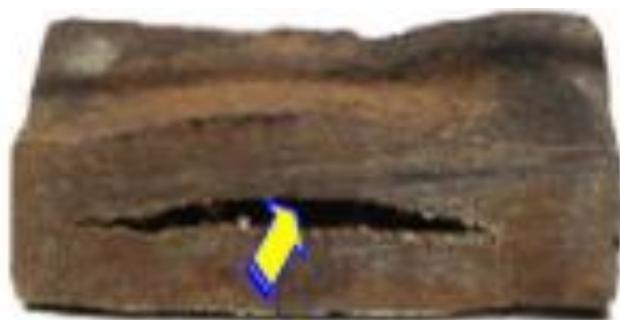
Figure I.11 : La fragilisation par hydrogène d'une pièce métallique
