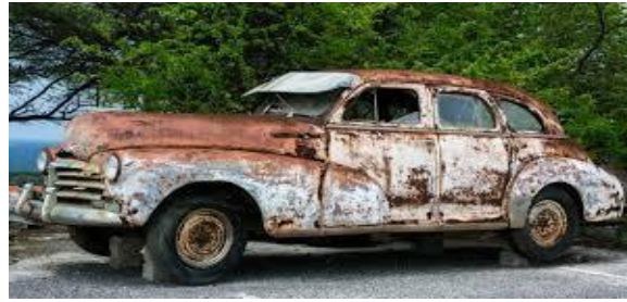
Figure I.8 : corrosion uniforme (corrosion d'une voiture)
