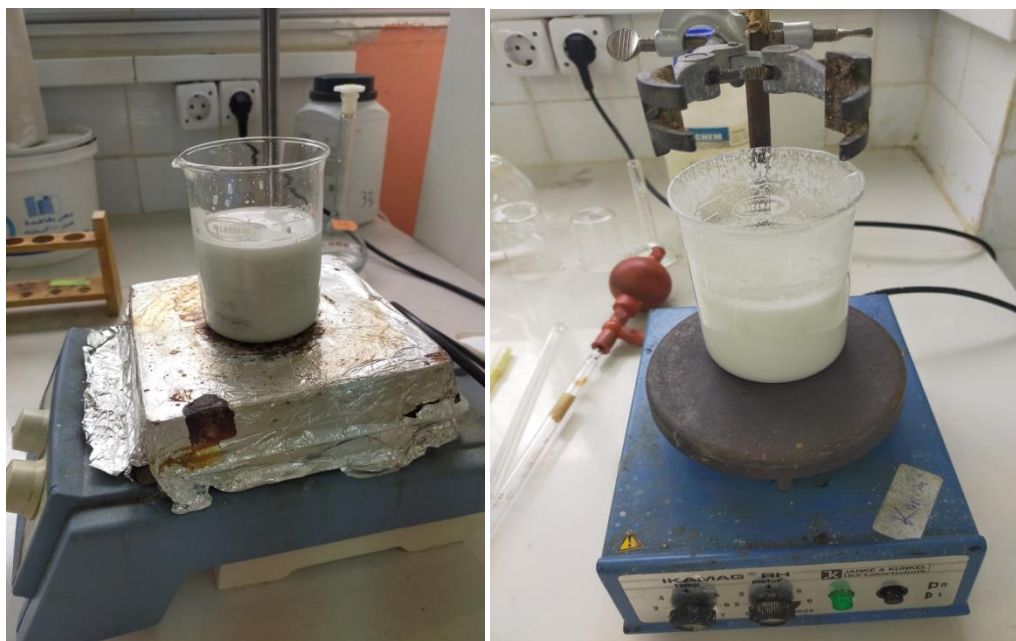
Figure III.2 : Mélange réactionnel sous agitation H01 avant ajout de TEOS (photo de gauche) et de H01 après ajout de TEOS (photo de droite).
