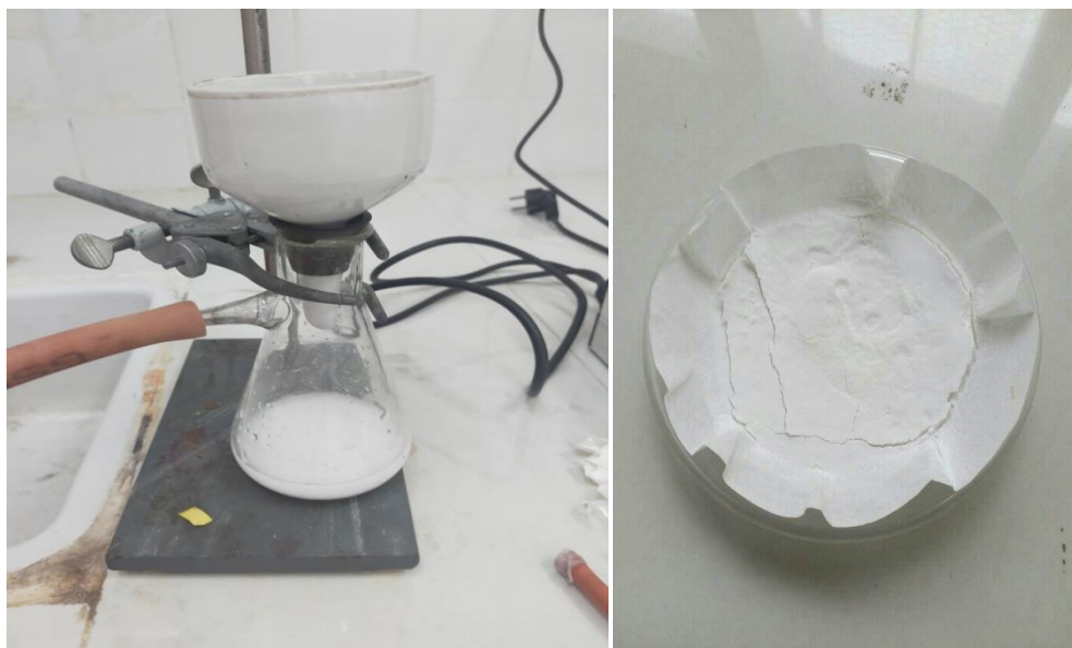
Figure III.5 : La filtration permet de récupérer le gel (à gauche). Le gel récupéré (à droite)
