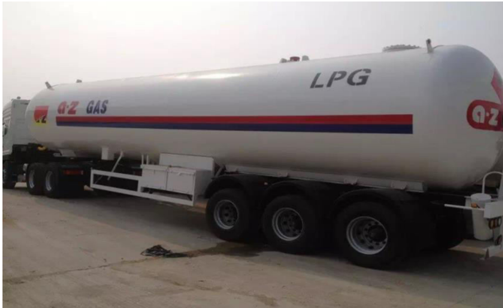
FIGURE II.6: TRANSPORT DU GPL PAR CAMIONS-CITERNES
