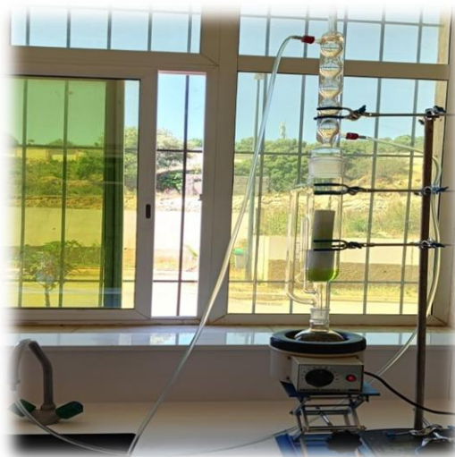
Figure 13: Extraction par soxhlet (photo originale).
