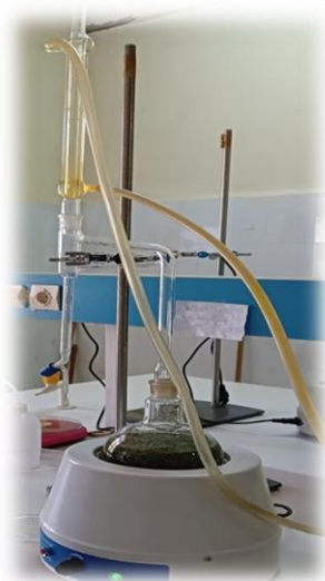
Figure12: Extraction par clivenger (photo originale).
