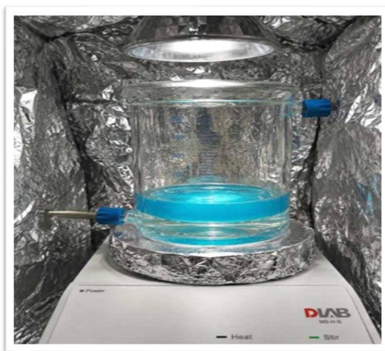
Figure II.6: Schéma du montage expérimental utilisé pour la photocatalyse
