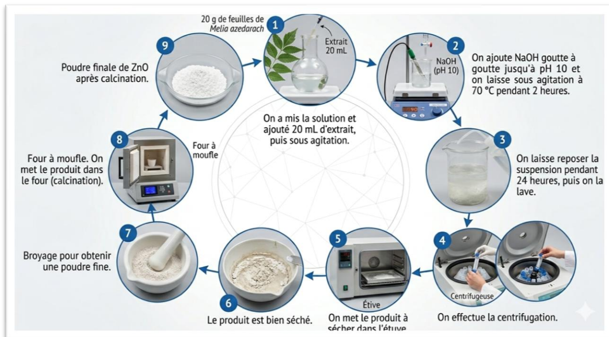
Figure II.3 : Les étapes de préparation des nanoparticules de ZnO
