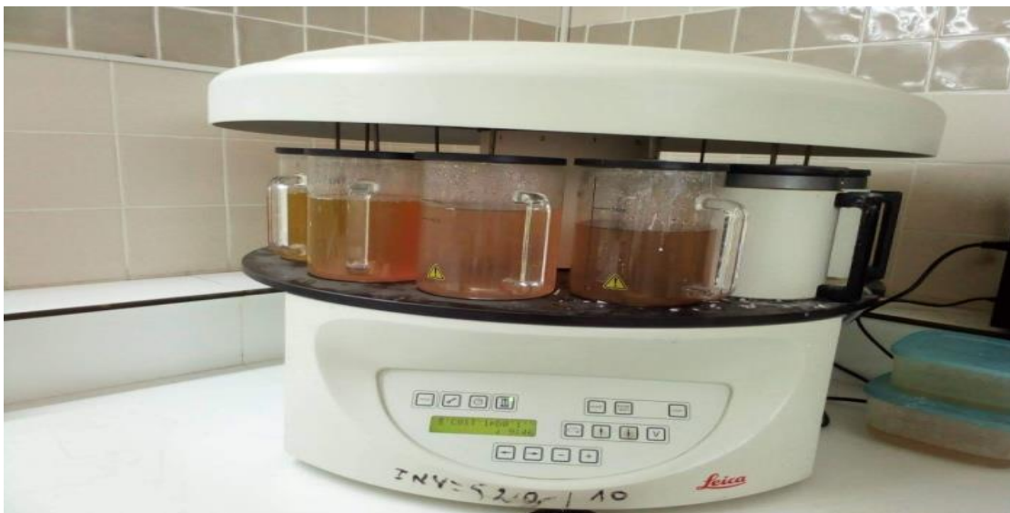
Figure 12: Déshydratation des prélèvements dans l'appareil automatisé
