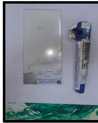
Figure III.23 : Peigne pour mesurer l'adhérence et papier contraste
