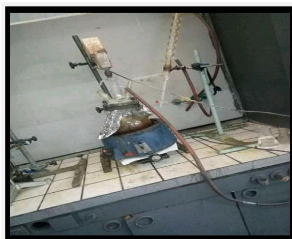
Figure III.11 : Montage de la synthèse du polyester (Ballon)
