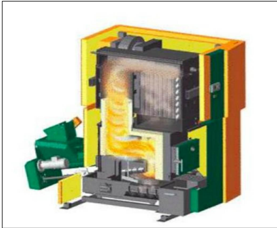
Figure II.4 : Chaudière à combustibles [15]
