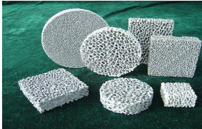
Figure III.12 : Exemple de mousses métalliques servant de support catalytique. [24]
