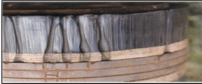
Figure I.9 : Usure par érosion [26]
