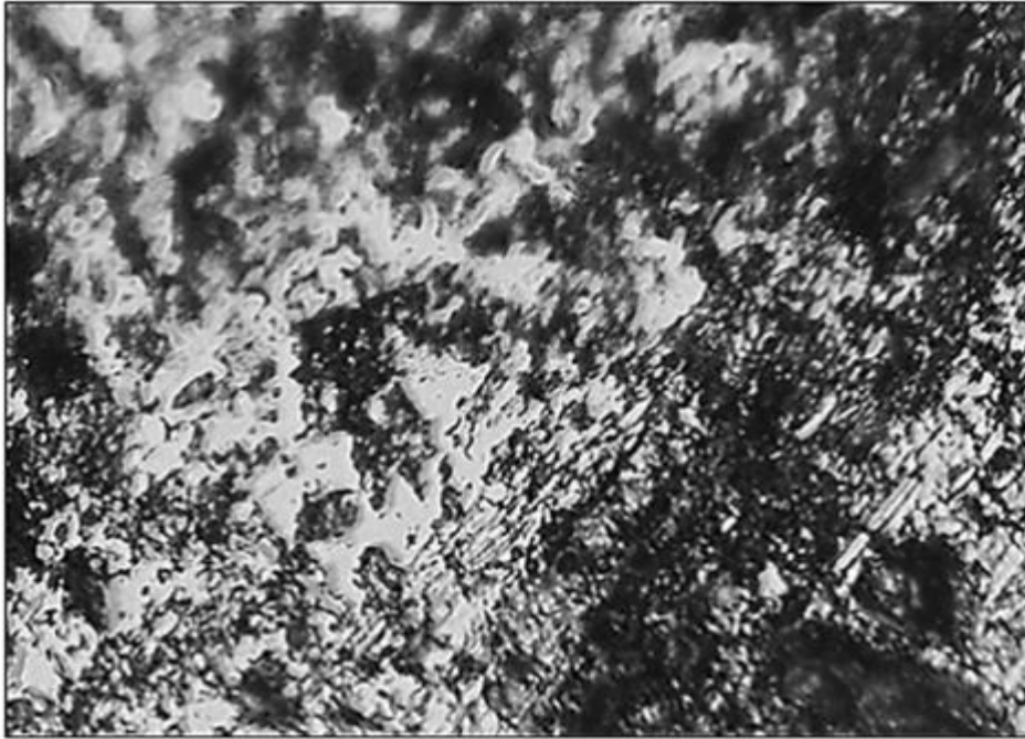
FigureV.16 : Photomicrographie optique (grossissement \times 60 ) d'un disque en acier - Surface après opération dans un contact EHL roulant contaminé et mésaligné
