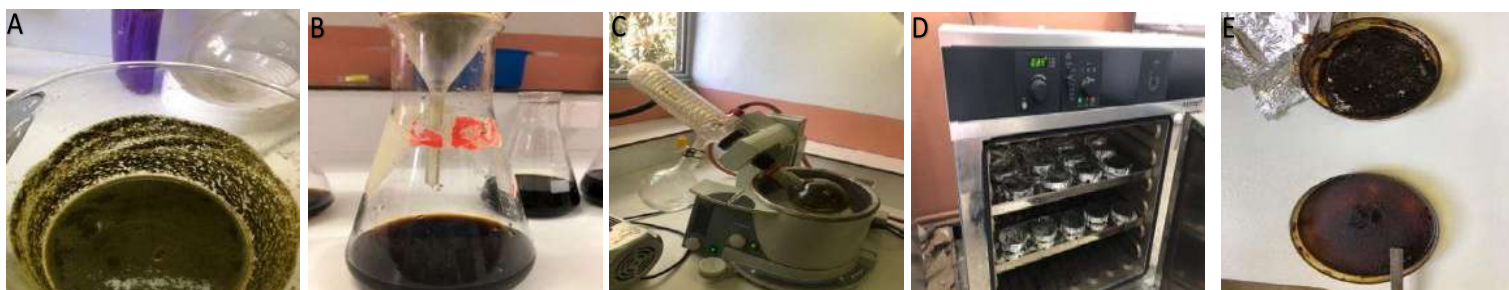
Figure 09. Étapes de préparation de l'extrait méthanolique. (A. extrait hydrométhanolique, B. filtration, C. séchage à l'aide d'un rotavap, D. séchage dans l'étuve, E. conservation dans une boîte de Pétri).
