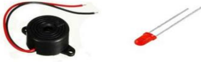
Figure III.17 : composant de système d'alarme (Buzzer + Led)
