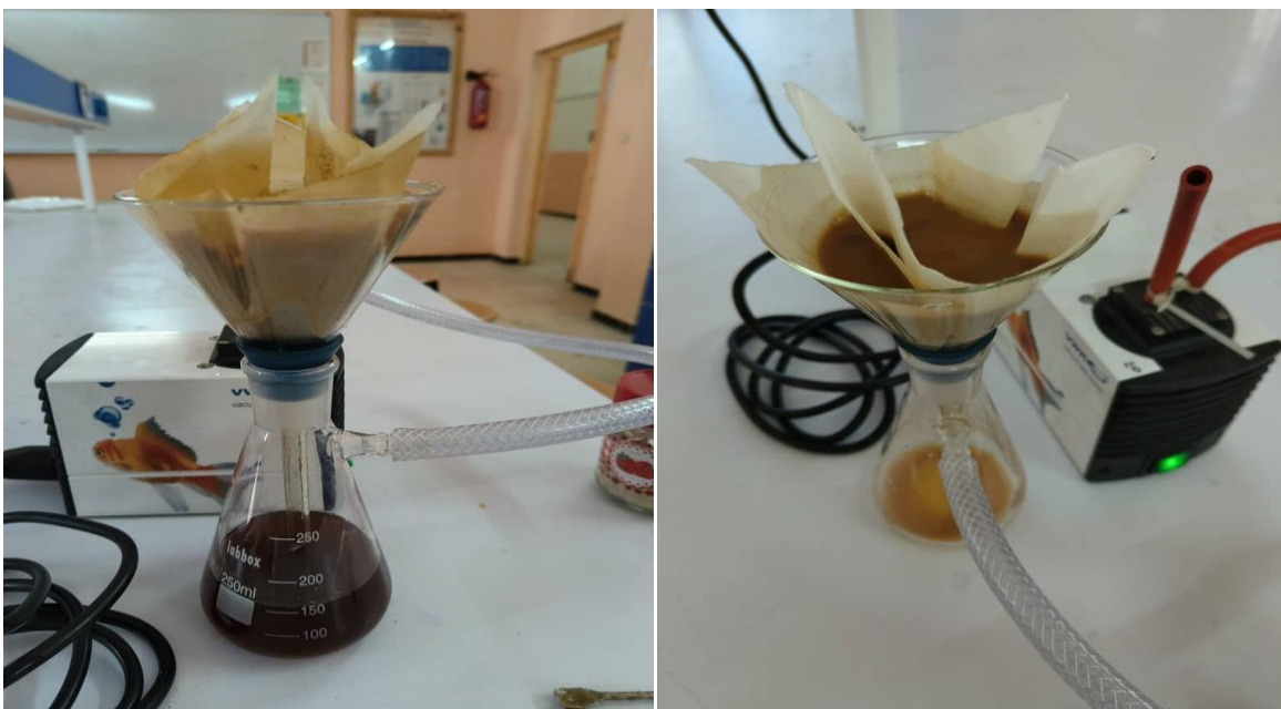
Figure IV.5. Montage de filtration
