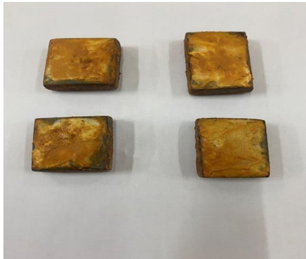
FigureIII.4 : Les échantillons après le séchage du tartre
