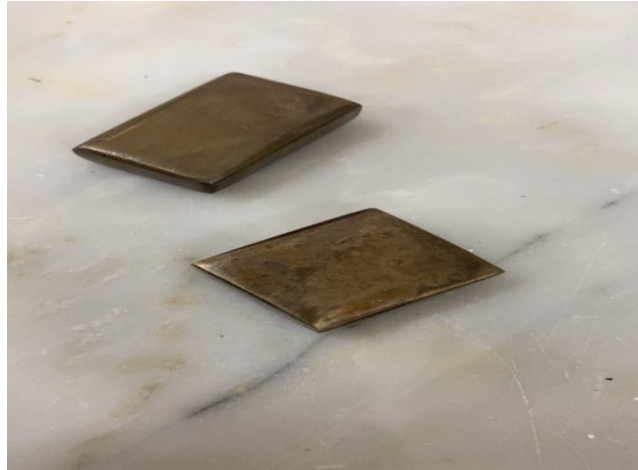
Figure III.7 : Un échantillon après la formation d'encrasse
