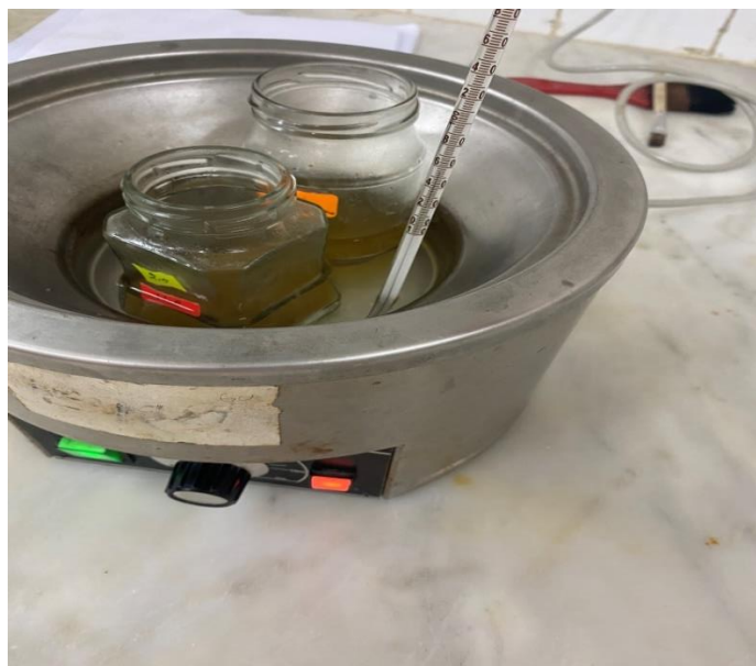
Figure III.8 : nettoyage d'échantillon entartré sous température
