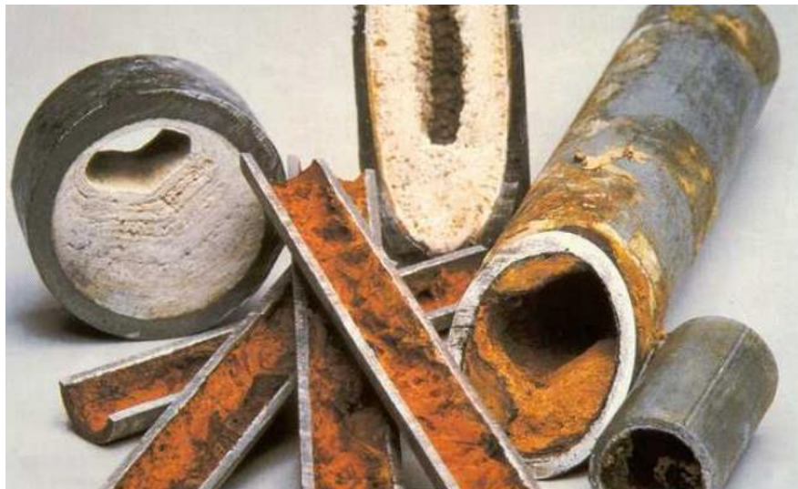
Figure II.2 : Dépôt de forte épaisseur dans un tube de surchauffeur de chaudière [5].
