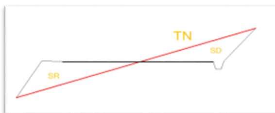
Figure II.11. Surfaces en déblai et remblai.
