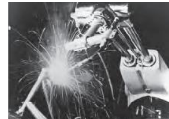
Hi-T-Hand le robot de soudage par points de Kawasaki, Japon
