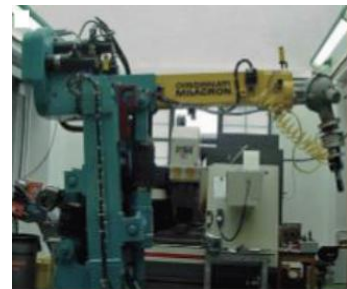
le premier robot industriel contrôlé par mini-ordinateur, le Cincinnati Milacron T3.
