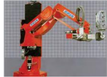
le premier robot doté de son propre système de contrôle de la société Reis, Allemagne.
