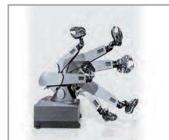
le Famulus (KUKA) premier robot au monde ayant 6 axes.
