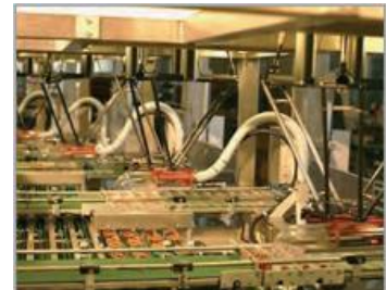
nouvelle structure Delta, Demarex, Suisse
