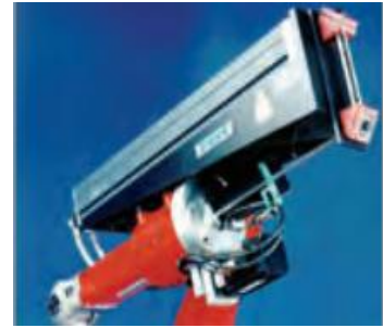
Le premier robot doté de système de guidage par laser intégré.
