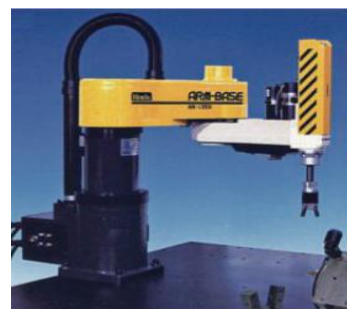
le premier robot SCARA développé par Hiroshi Makino en 1978, Le Hirata AR-300.
