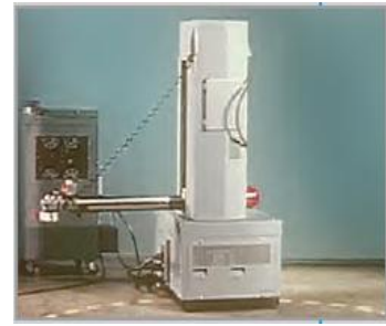
Le premier robot cylindrique, le Versatran
