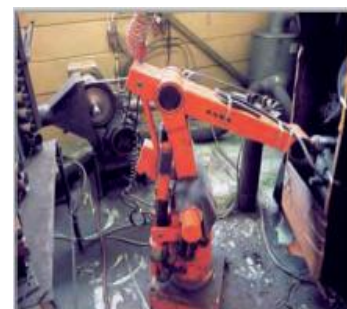
l'IRB 6 premier robot industriel entièrement électrique.
