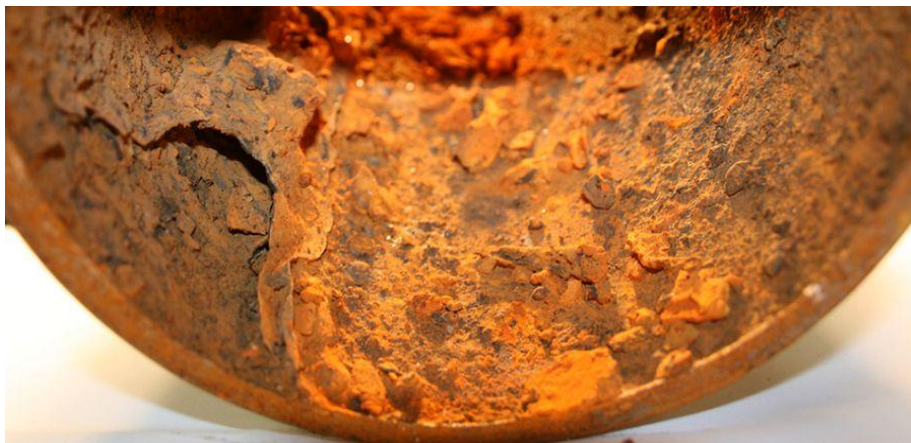
Figure. I.16. Corrosion généralisée d'un d'acier au carbone.
