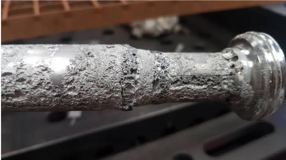
Figure. I.14. Corrosion caverneuse d'un l'acier inoxydable.
