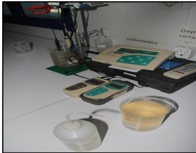
Figure III.2 : Appareillage de mesure pH mètre, Thermomètre et Conductimètre.
